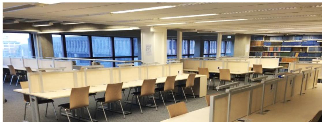
Doppelarbeitsplätze mit Mitteltrennwand, komplett elektrifiziert mit flächenbündig eingelassenen Steckdosen und Arbeitsplatzleuchten
