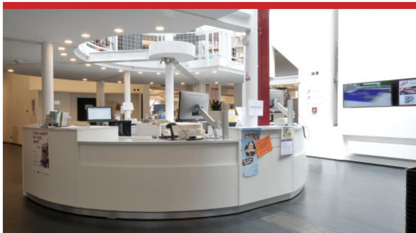
elektrisch höhenverstellbare Thekenanlage mit Mineralwerkstoff, Beleuchtung und Pfeilereinbau
